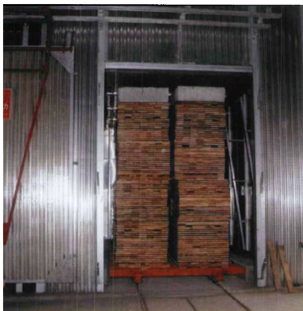
材堆顶部置混凝土预制块
