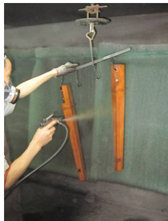
喷涂工房的过滤装置
